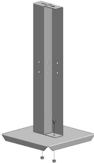
Verschrauben Sie im ersten Schritt nach Entpacken der Komponenten die Standpfosten mit den Fußplatten. Verwenden Sie hierzu Schrauben M8x20 nebst dazu gehörigen Muttern.
