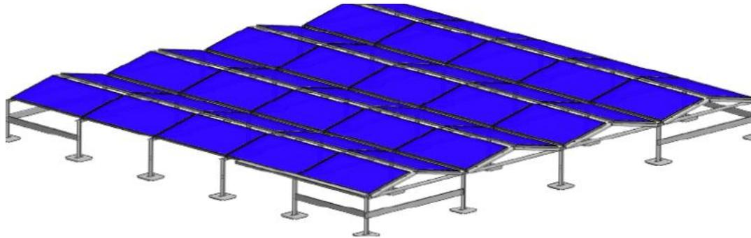
**Generell gilt:** Bauen Sie in jeder Richtung und auf jeder Seite mindestens zwei Versteifungsbleche ein. Bei Unterbrechungen bzw. an Innenecken und Außenecken müssen ebenfalls Versteifungen eingebaut werden. Verschrauben Sie die Bleche mit Schraube M8x16 und Mutter M8 an Standpfosten der betreffenden Positionen. Verwenden Sie die dafür vorgesehenen Löcher in den Standpfosten.
