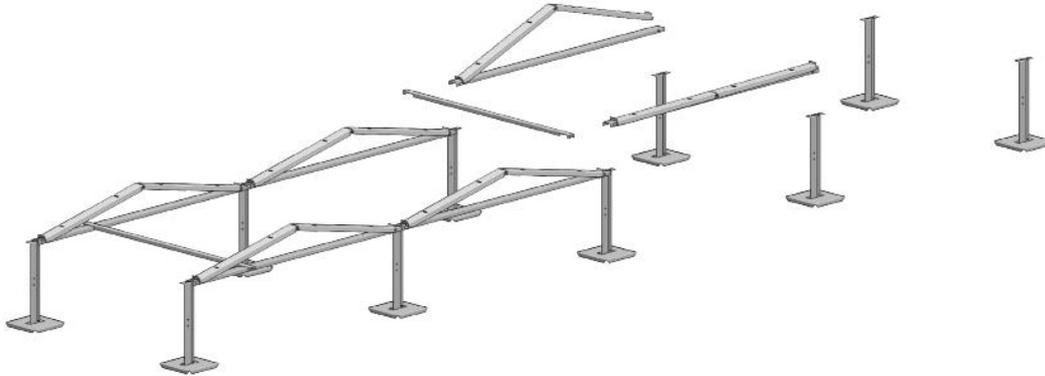
Jetzt werden die Schenkel der Konsole aufgerichtet und vorn auf die bereits in der Zugschiene vormontierten Schrauben gesteckt. Anschließend wird die Konsole ausgerichtet und danach alle Schraubverbindungen angezogen.
