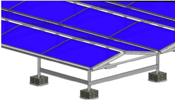
Verteilen Sie den Ballast auf den Fußplatten. Der Ballast kann sowohl mit Betonsteinen oder Säcken gefüllt mit Riesel oder Kies aufgebracht werden. Verhindern Sie insbesondere ein versehentliches Kippen von Betonsteinen etc.
