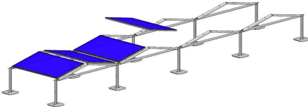
Die Kante des Modulrahmens sollte auf beiden Seiten mittig aus der Mitte des Ständers liegen. Ziehen Sie jetzt die Endklemmen an mit **6 Nm ohne Schlag**. Stecken Sie als nächstes die Mittelklemmen in die dafür vorgesehenen Schlitze der Konsolen.
