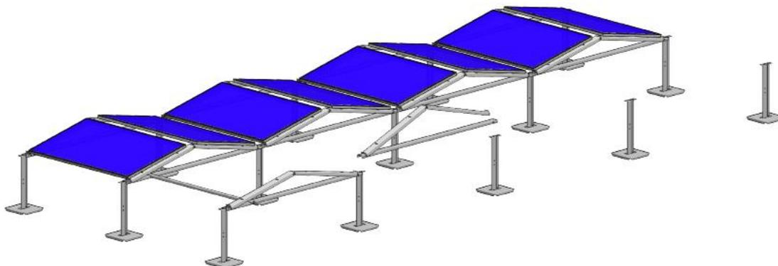
**Bitte beachten:** Niemals beispielsweise zuerst alle Standpfosten und Konsolen anbringen und erst danach die Module. Eine Abweichung von dieser Montageabfolge kann zu erheblichem Mehraufwand bei der Verlegung der Module führen.
